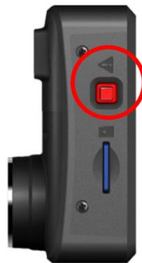
**G-Sensor Notfall-Aufnahme:** Während der Videoaufzeichnung aktiviert die DrivePro automatisch die Notfallaufzeichnung, wenn eine Kollision erkannt wird.
